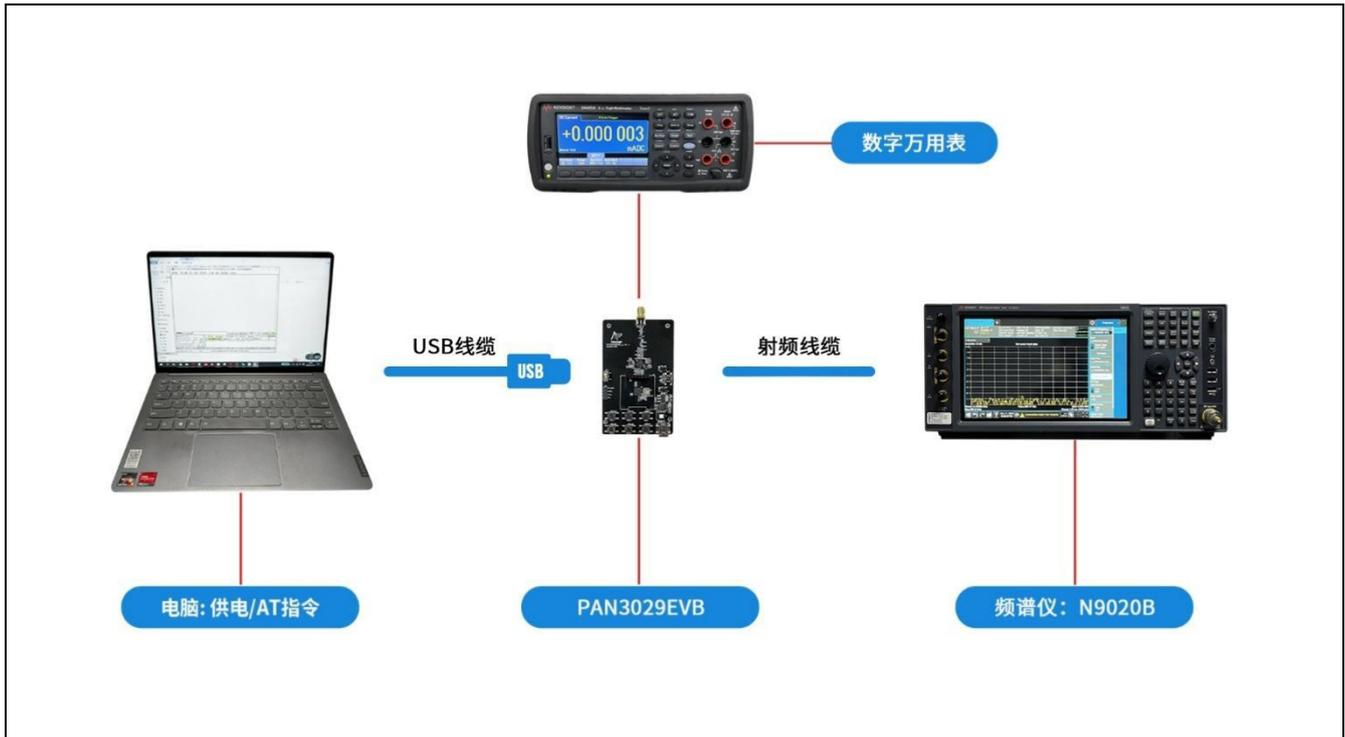
图 3-3 发射功率和电流测试环境
