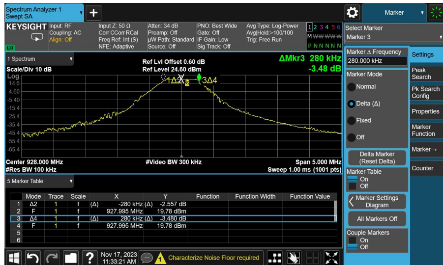
图 3-1.2 928MHz 500KHz MIN 6dB OBW
