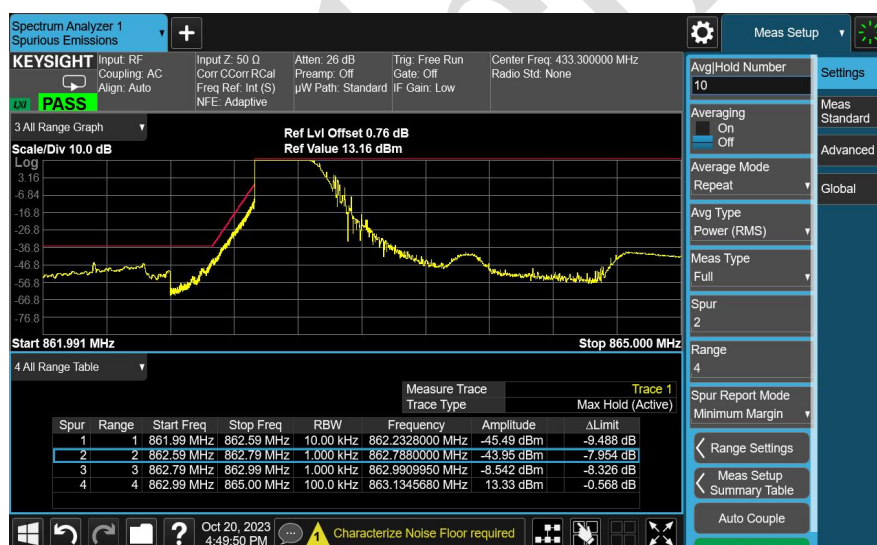
图 2-2.21 863.125MHz 250KHz OOB (OFB 模板) Emissions
