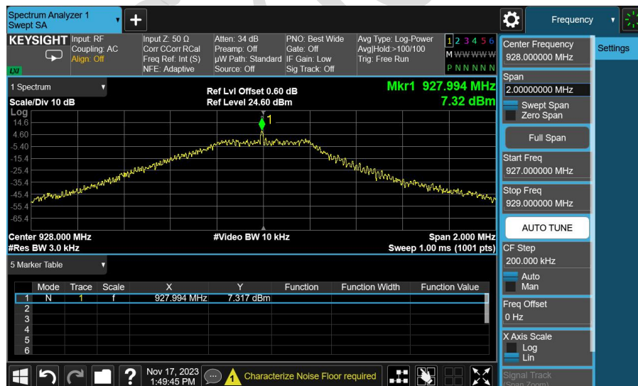
图 3-2.2 928MHz 500KHz 8dBm in any 3 kHz
