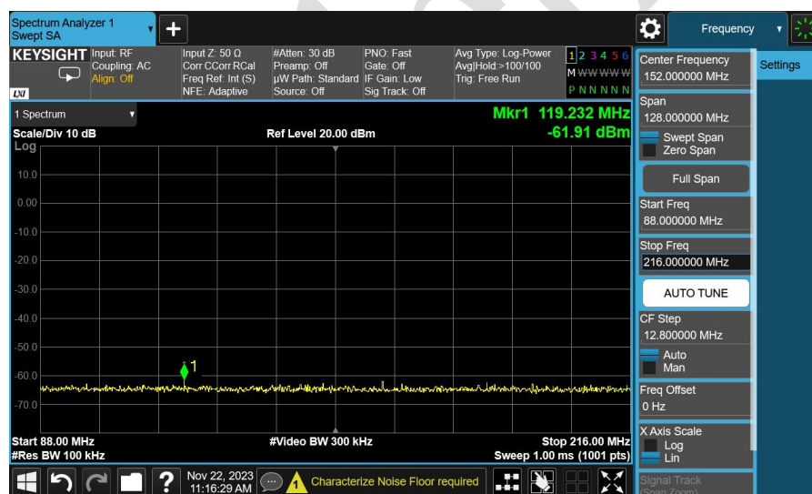
图 3-1.13 TX:928M 500K TEST BAND:88~216M
