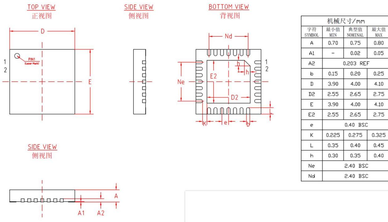
图 2-1 PAN3029 QFN32 4\*4 芯片封装尺寸图
