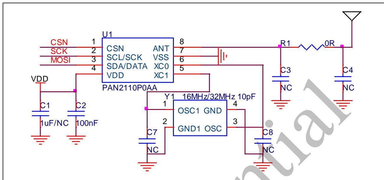
图 11-1 SOP8 参考原理图
