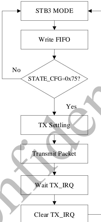
图 8-1 普通单包发送模式状态流程图
