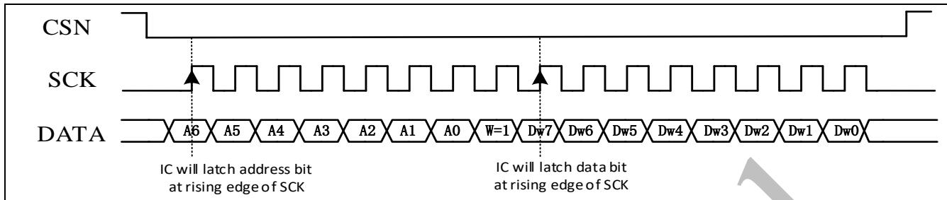
图 9-1 三线 SPI 写时序
