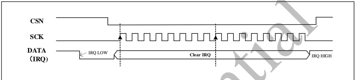
图 9-8 三线 SPI DATA 复用 IRQ 时序
