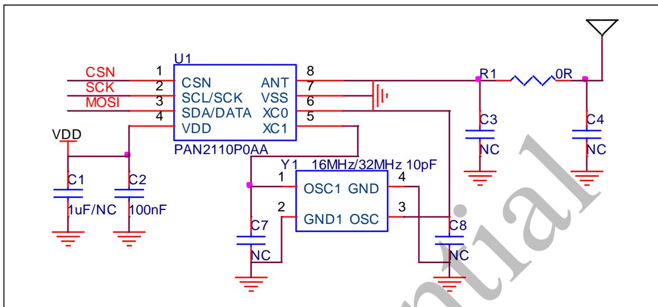
图 11-1 SOP8 参考原理图
