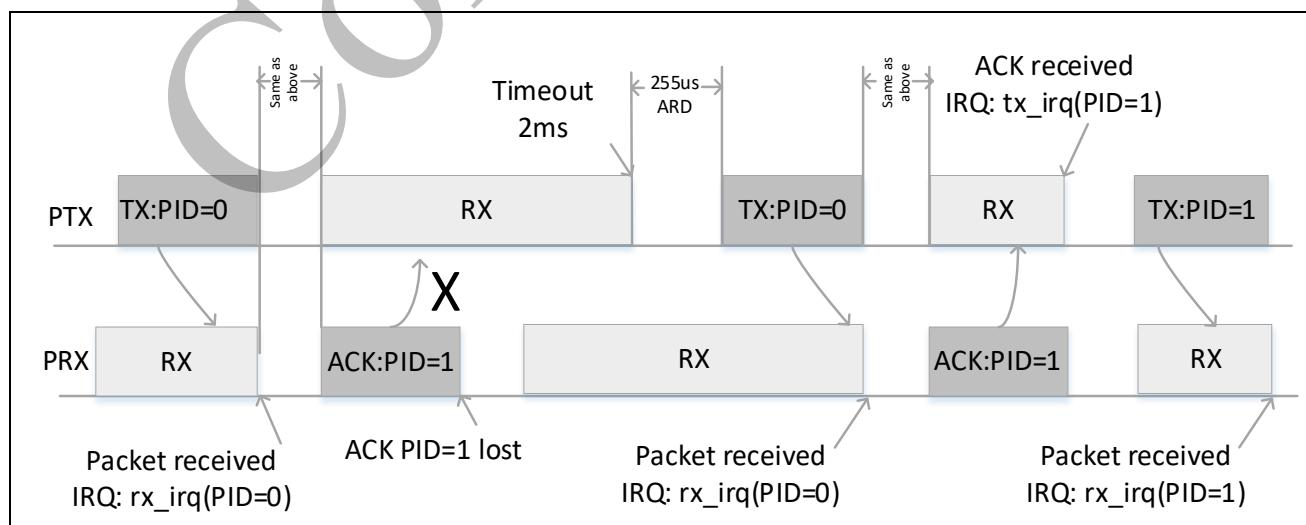
图 8-10 增强型发送端丢失 ACK 时序图
