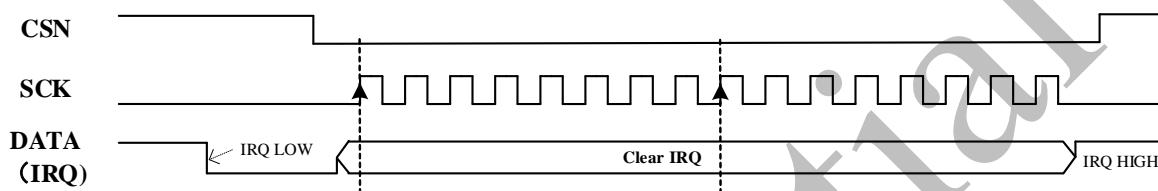
图 9-8 三线 SPI DATA 复用 IRQ 时序
