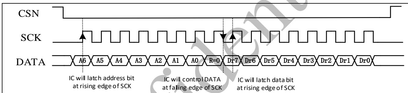
图 9-2 三线 SPI 读时序
