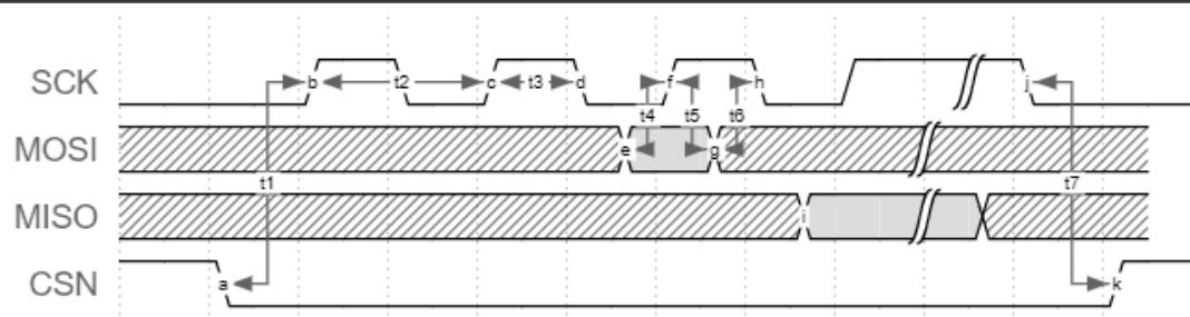
图 7-5 四线 SPI 时序要求图
