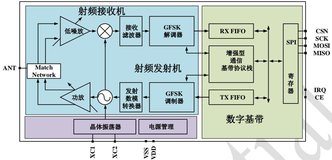
图 1-1 XN297L 芯片系统结构方框图
