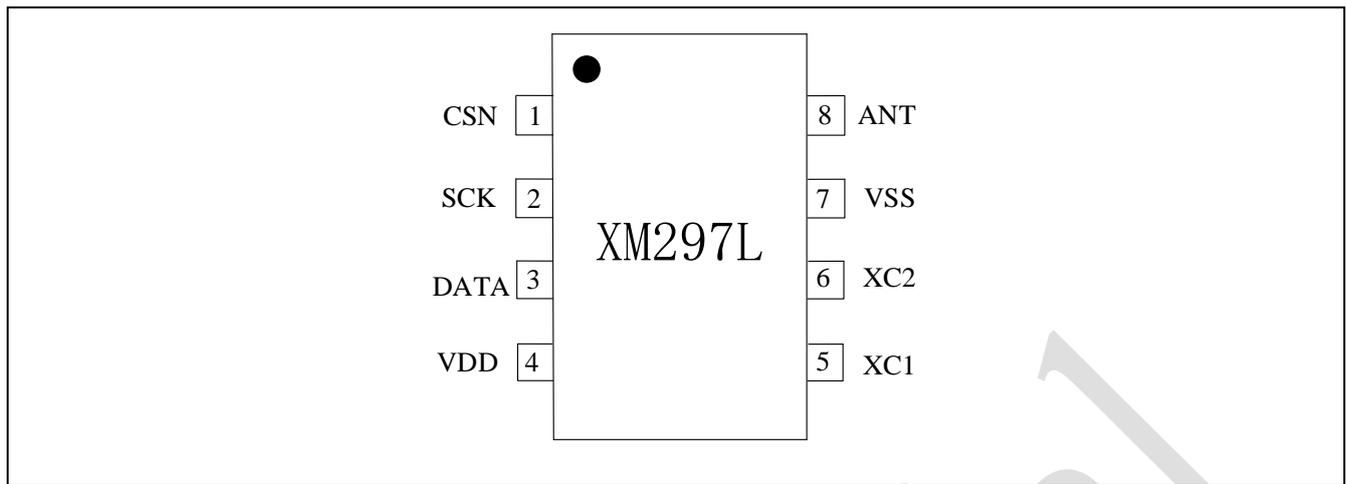
图 2-3 芯片引脚图（SOP8 封装）
