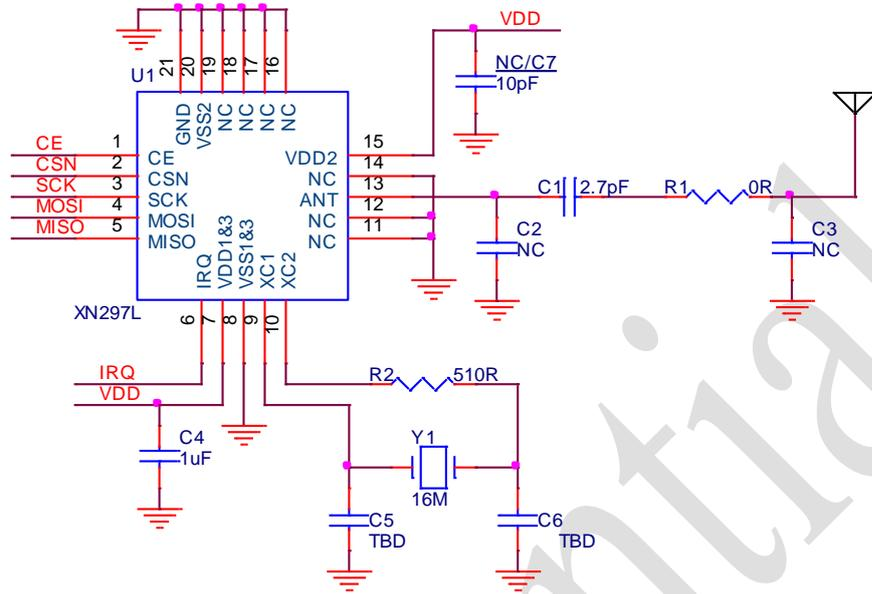
图 9-1 QFN20 3\*3 封装原理图
