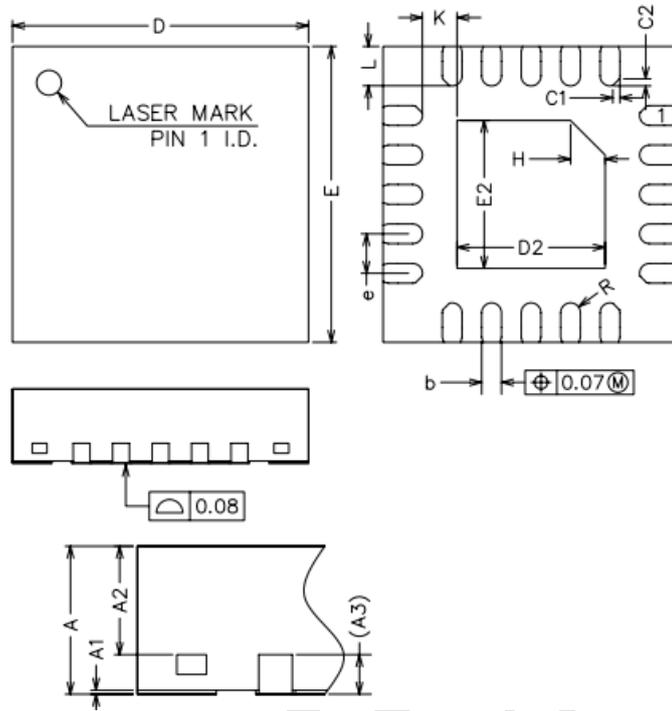
图 10-1 QFN20 3\*3 封装图
