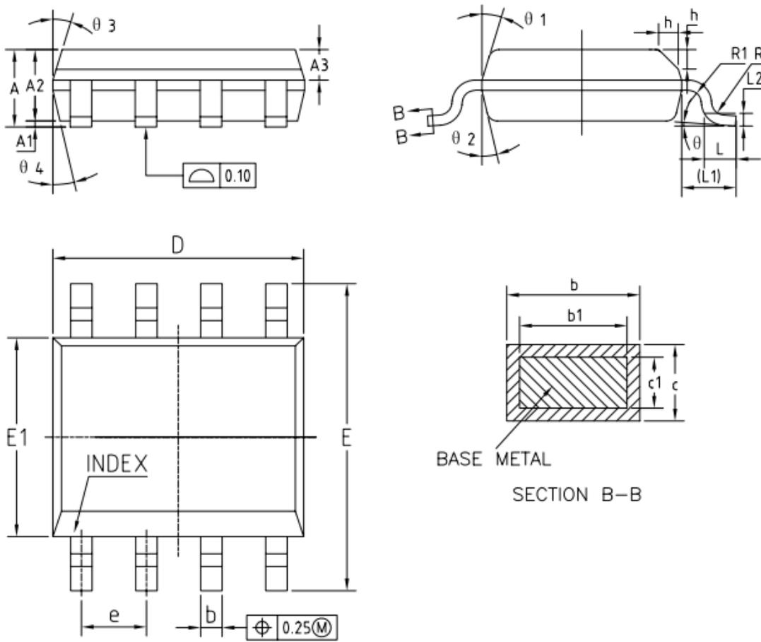
图 10-2 SOP8 封装图
