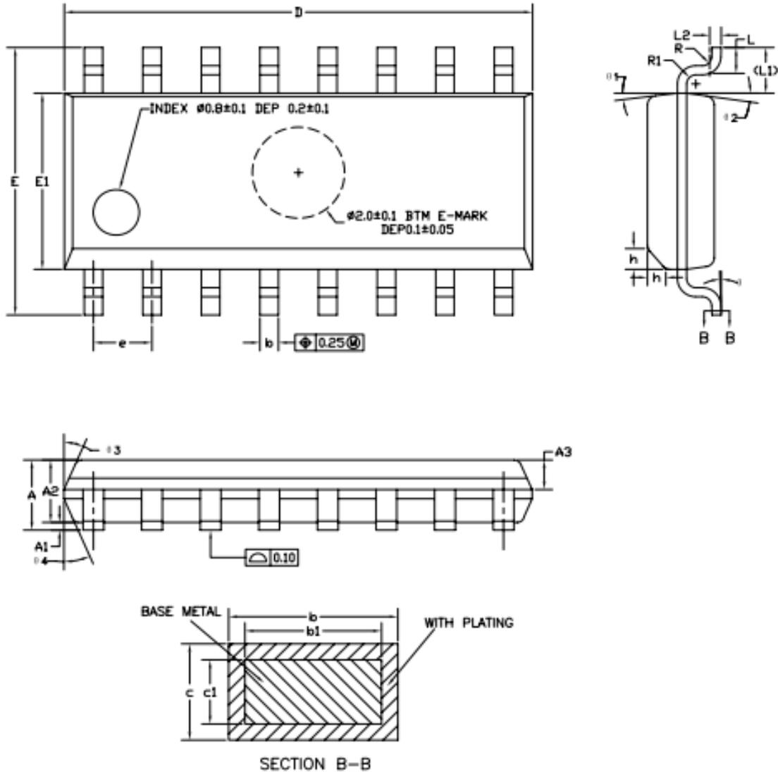
图 10-3 SOP16 封装图
